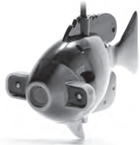
Caméra en forme de poisson avec lumières Explorer et câble. L'Explorer 5 possède un câble de 50 pieds.
